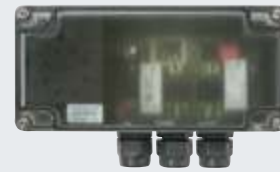
2-Kanal Relais-Empfänger HET-E2 24 BS mit 2 potentialfreien Relais-Ausgängen für Richtungswahl, einen 2-poligen Eingang für potentialfreie Endlagenmeldung Tor-Auf / Tor-Zu (zur Abfrage der Torposition)
